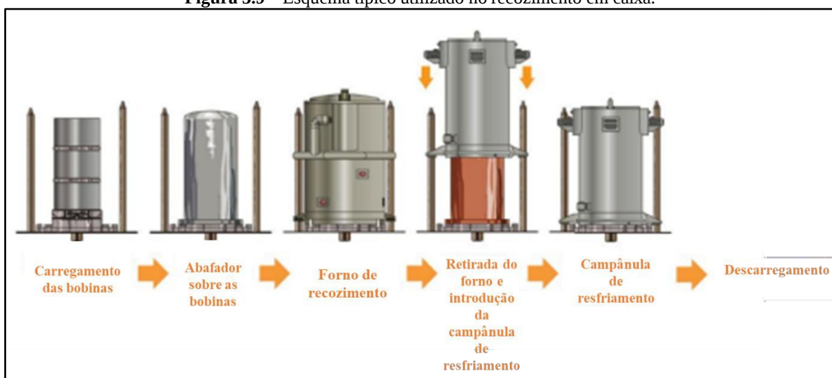
Figura 3.9 – Esquema típico utilizado no recozimento em caixa.
