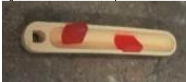
Figura 4.3 – Amostras recozidas após a retirada do forno.
